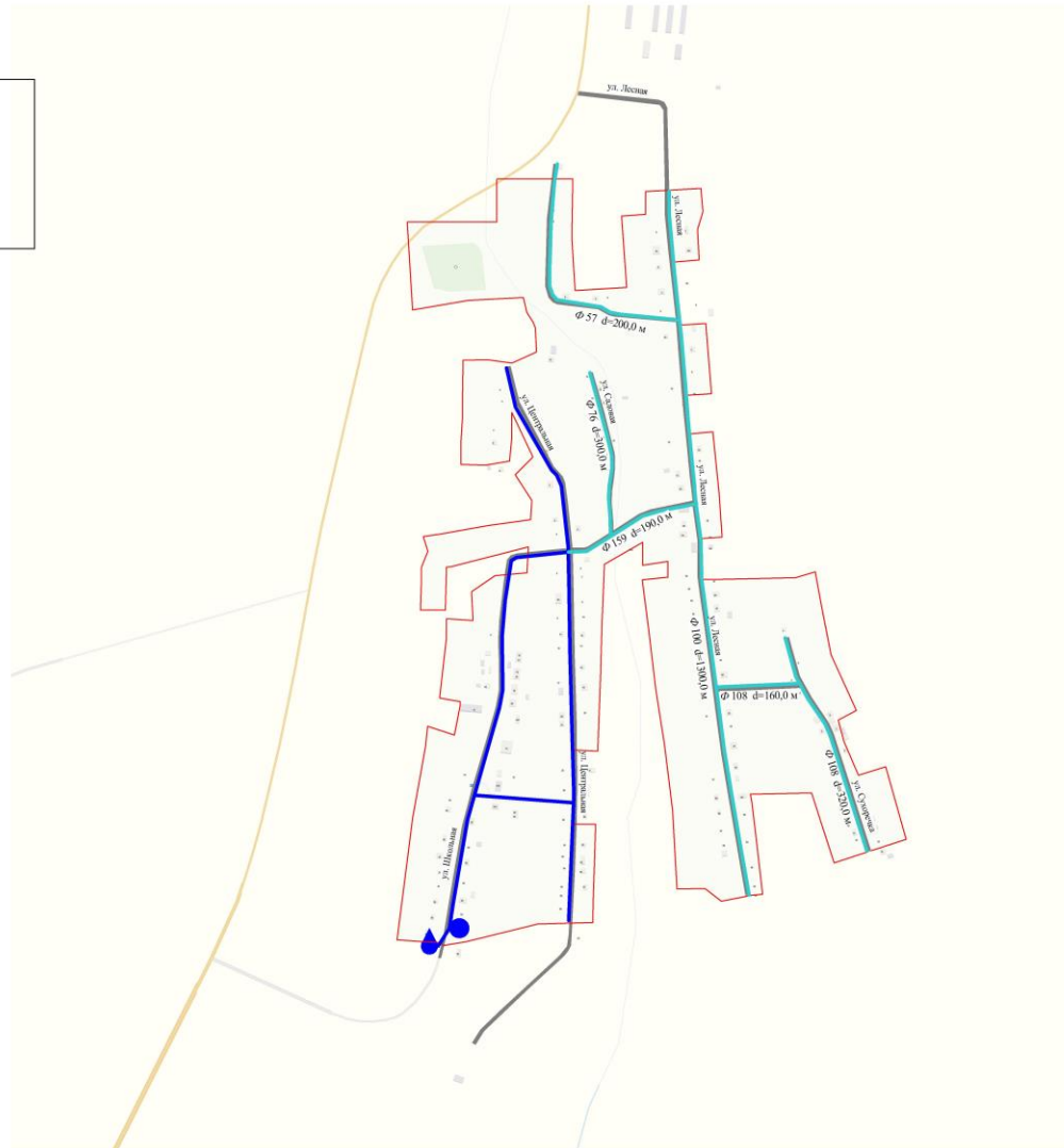
Рис. 3 - Схема существующего и планируемого водоснабжения с. Никиткино сельского поселения Старое Усманово муниципального района Камышлинский
