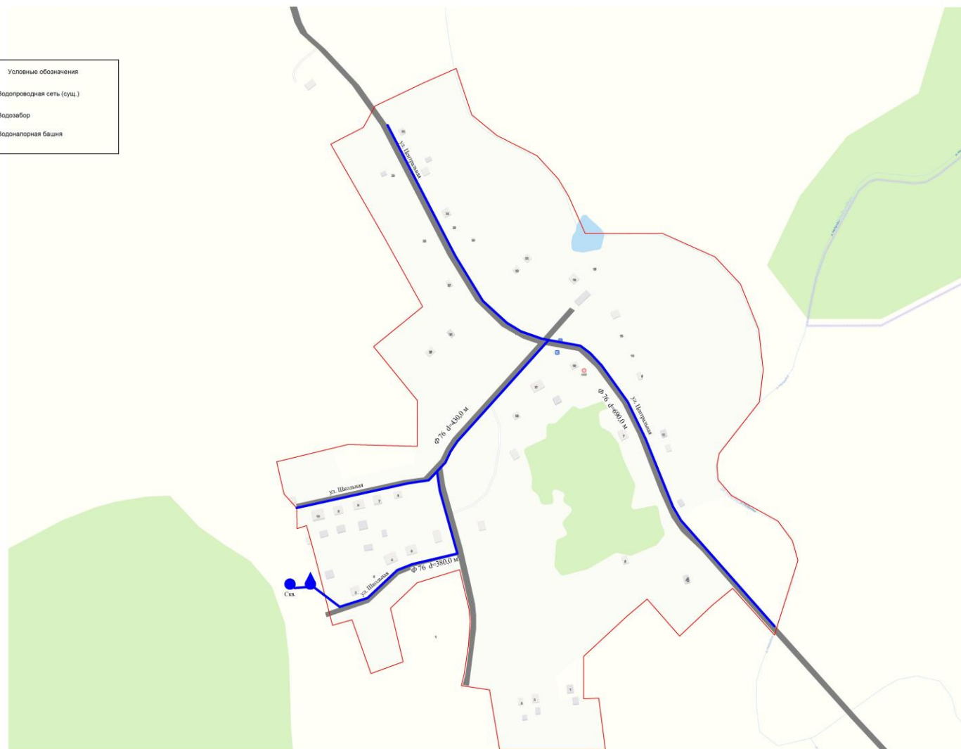
Рис. 2 - Схема существующего и планируемого водоснабжения с. Неклодово сельского поселения Старое Усманово муниципального района Камышинский
